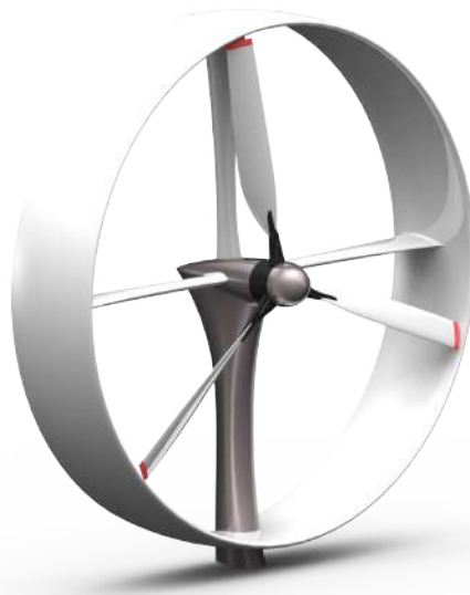
Figura 7.8: Elica con carenatura (per missione Humanitarian Relief ).
